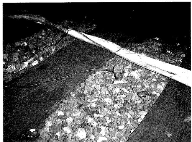
**FIG. 19** Géophone posé sur le ballast.
