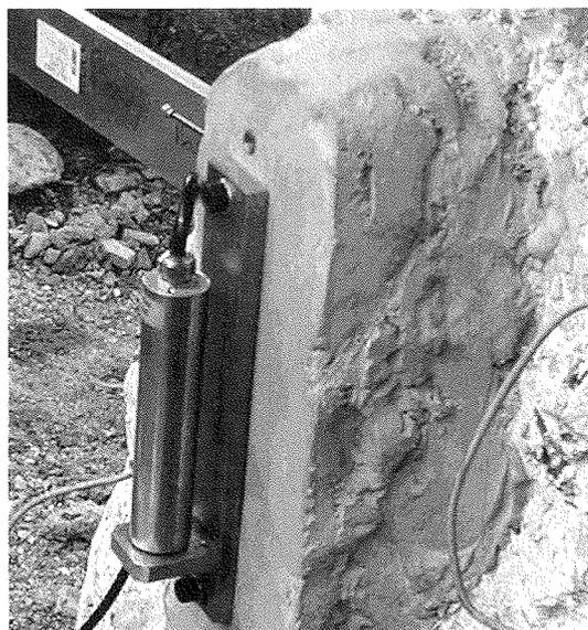
**FIG. 5** Photographie d'un inclinomètre.
