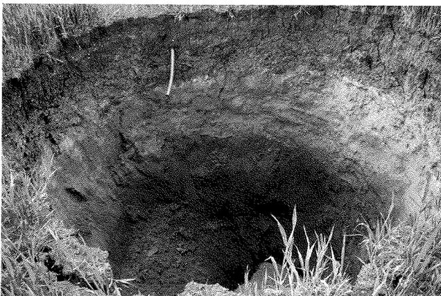
**FIG. 6** a) Parois de fontis sub-verticales après effondrement de la surface ; b) dans le même secteur, ancien fontis présentant une allure de cuvette.
