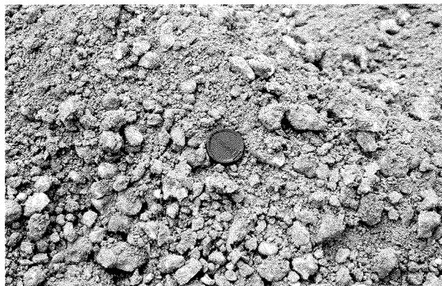
**FIG. 12** Aspect de « l'argile à silex » pré-traité à la chaux, criblé, concassé puis recomposé.
