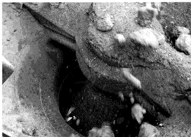
**FIG. 11** Conasseur giratoire en action, réduisant les silex de taille comprise entre 70 et 100 mm.
