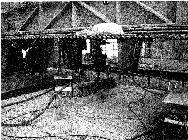
FIG. 3 Traverse en place et dispositif de chargement.
