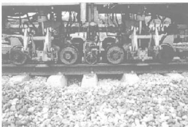
**FIG. 16** Affaissement de la surface du remblai SNCF2 lors du passage du simulateur de trafic.
