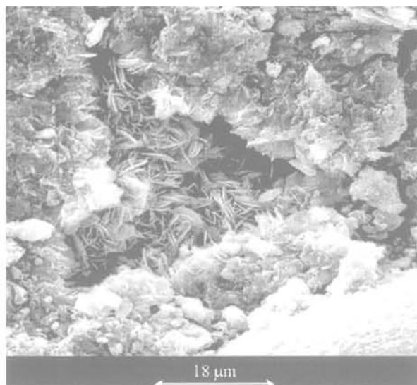
**FIG. 5** Phyllosilicates ferrifères cristallisés sur les parois d'un vide ouvert dans les phyllosilicates diagénétiques. Minerai de fer sain.
