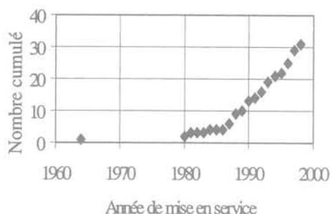
**FIG. 5** Nombre cumulé de centrifugeuses mises en service au Japon d'après les données de Kimura (2000).
