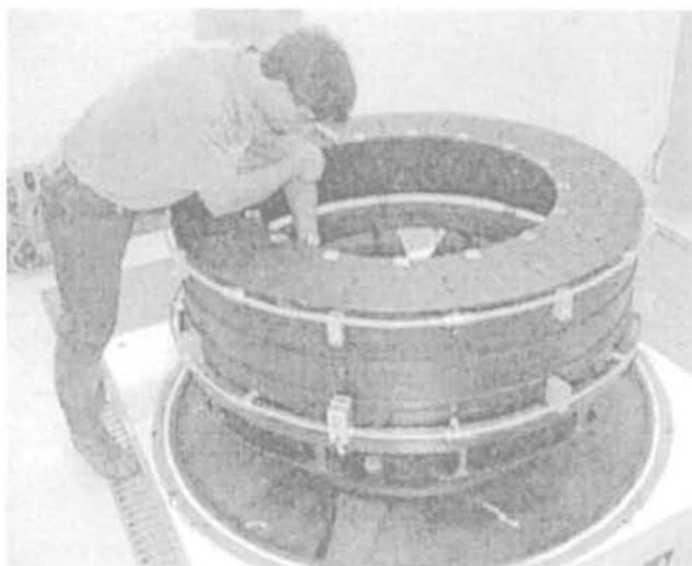
**FIG. 7** Centrifugeuse tambour de l'université de Perth.
