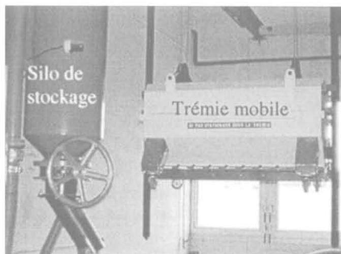
(b) Trémie automatique et système pneumatique de chargement du sable.
