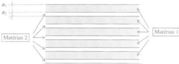
FIG. 6 Modèle idéalisé de massif stratifié.
