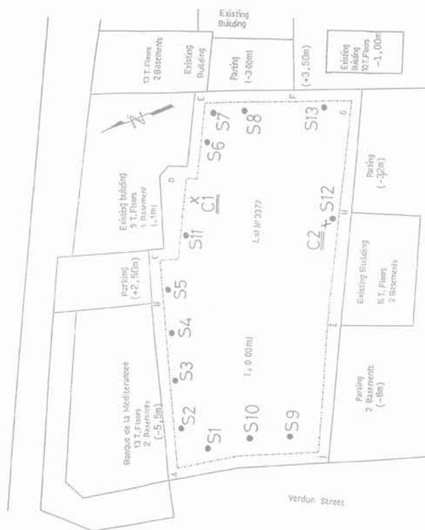
FIG. 1 Schéma d'implantation des sondages
