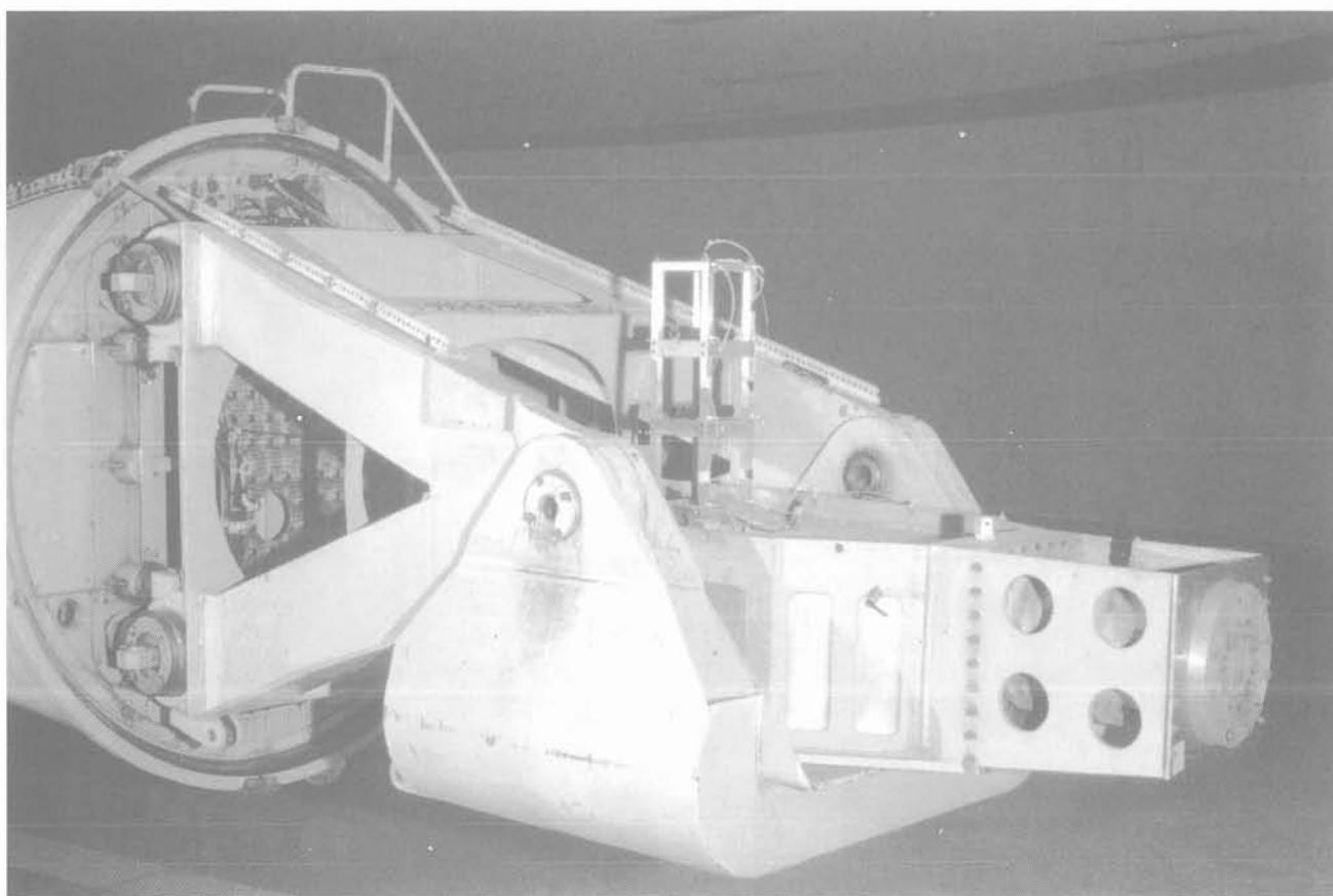
Fig. 2. — Générateur d'onde sismique pour essais en centrifugeuse (CESTA).
