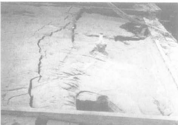
**Fig. 7. — Fissures de surface après rupture du massif cloué.**
