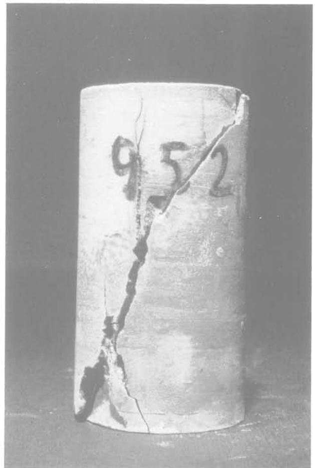
Fig. 21. — Localisation de la déformation dans une éprouvette longue d'argile raide.
