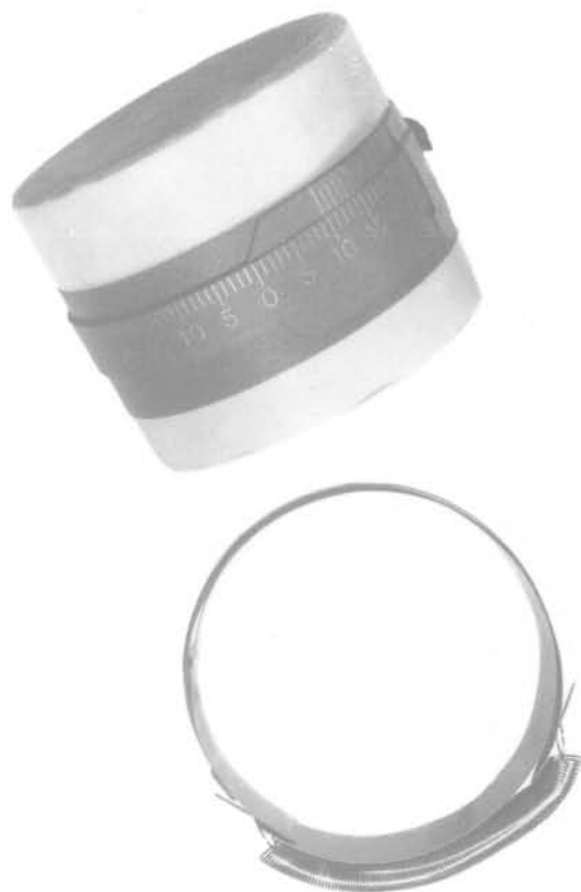
Fig. 2 Bague de mesure des déformations radiales des éprouvettes
