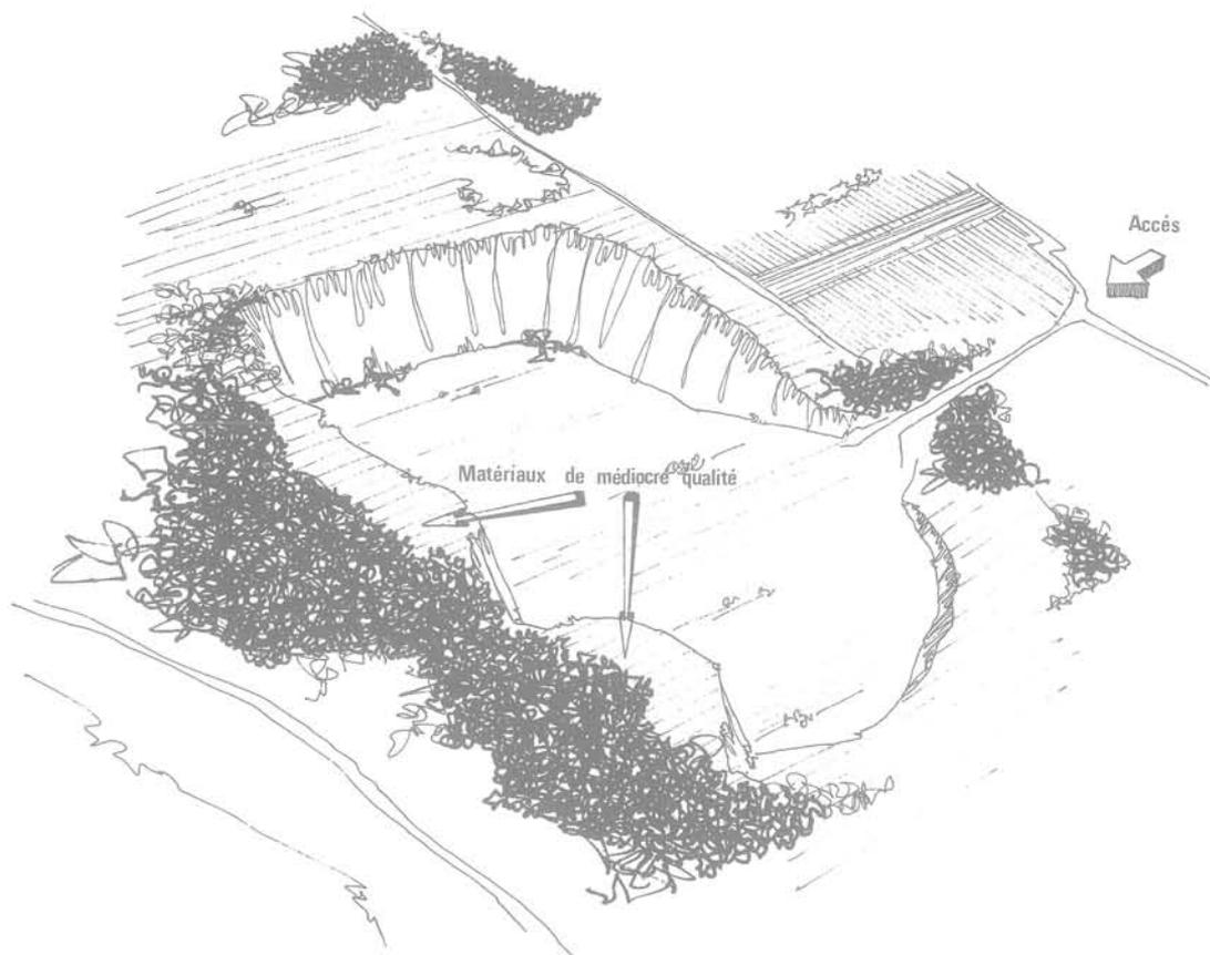
Fig. 3 - Prise en compte des hétérogénéités du matériau permettant de conserver au site une partie de sa végétation et d'isoler la carrière du milieu environnant (vue, bruit, poussières).
