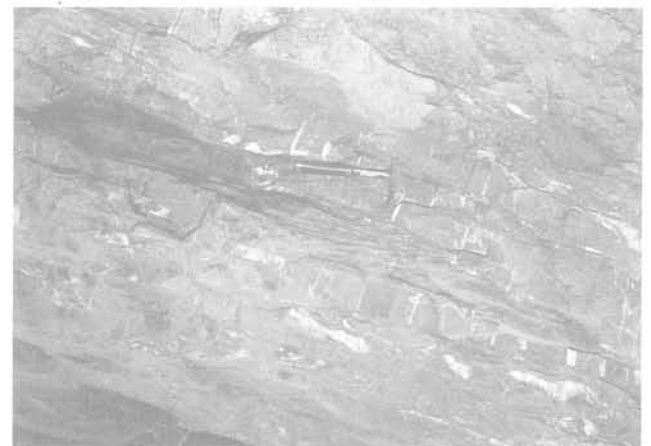
Fig. 16 Faciès «calcschiste» des schistes lustrés. Vue du front au PM 6500
