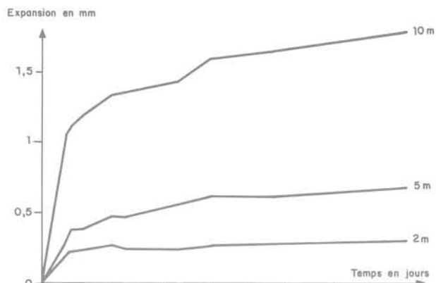
Fig. 46 PM 2295 — Expansion mesurée parallèlement à la schistosité
