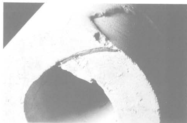
Fig. 17 Ligne de glissement macroscopique sur l'éprouvette
