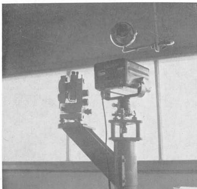
Fig. 18 a. — Le distancemètre utilisé à Asbestos.
