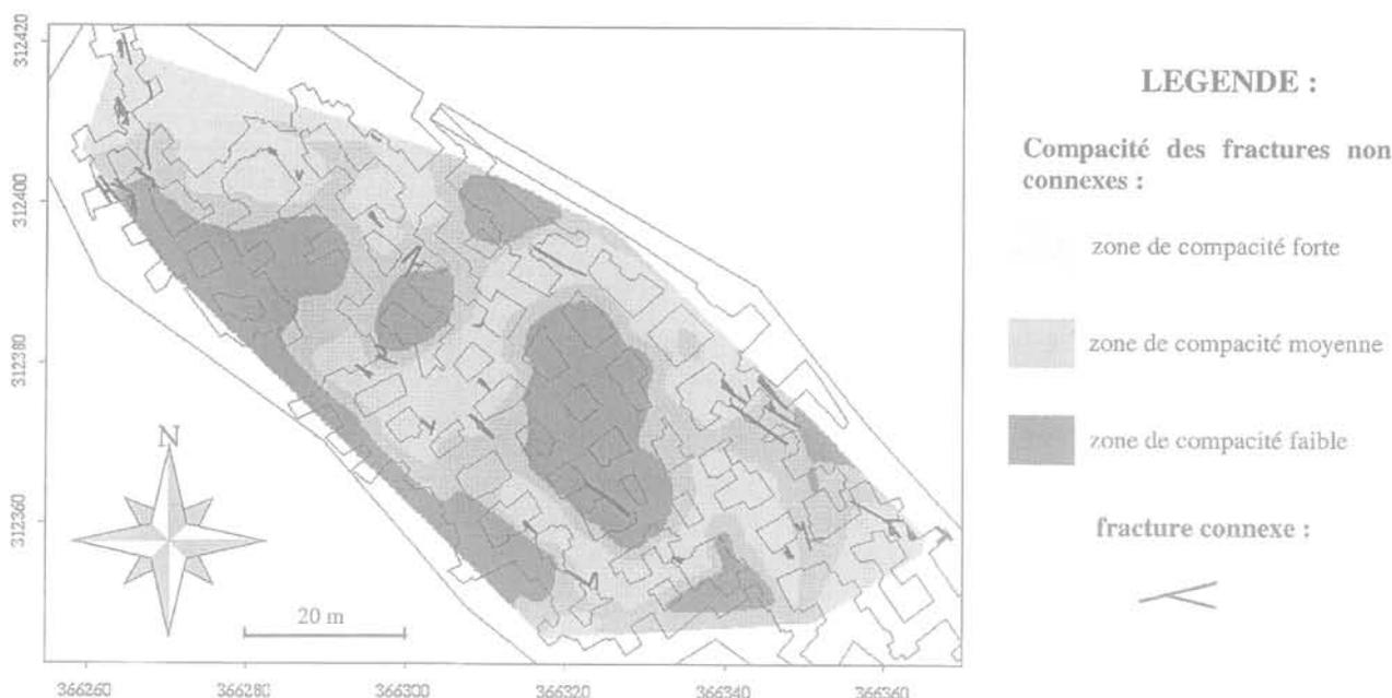
FIG. 11 Fractures non connexes et connexes dans la carrière de Thau niveau II.
