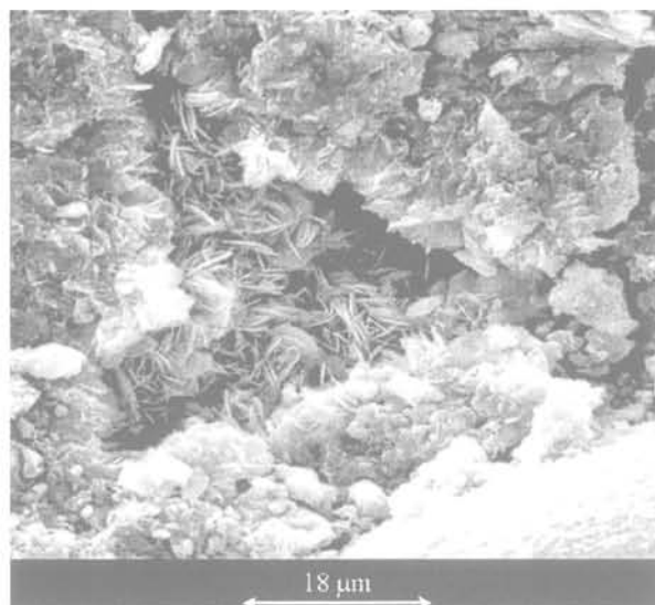
FIG. 5 Phyllosilicates ferrifères cristallisés sur les parois d'un vide ouvert dans les phyllosilicates diagénétiques. Minerai de fer sain. Iron phyllosilicates crystallized on vacuum walls opened in diagenetic phyllosilicates. Healthy iron ore.
