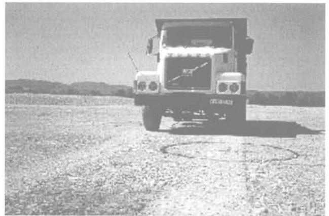
FIG. 10 Orniérage obtenu après les essais de traficabilité (cavité SCET1).
