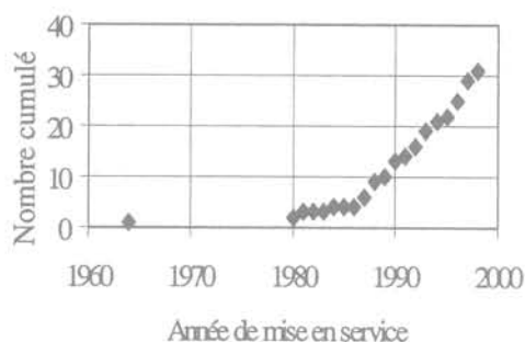
FIG. 5 Nombre cumulé de centrifugeuses mises en service au Japon d'après les données de Kimura (2000). Cumulative capacity (in tonne x g) of the large centrifuges listed in Table I (radius larger than 3 m).
