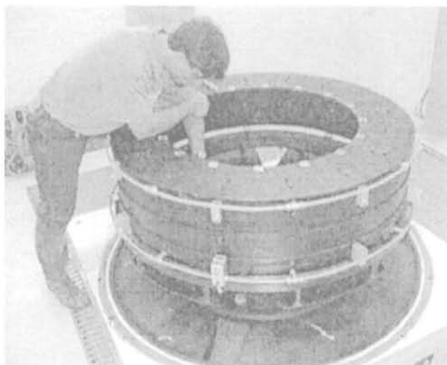
FIG. 7 Centrifugeuse tambour de l'université de Perth. The Perth University drum centrifuge.
