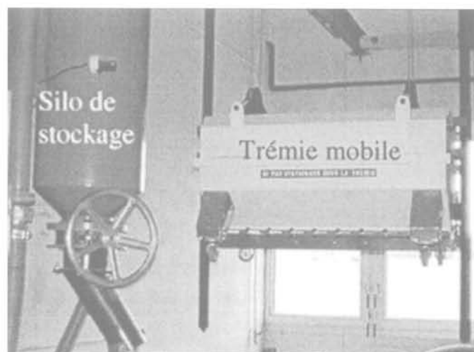
(b) Trémie automatique et système pneumatique de chargement du sable. Automatic hopper and pneumatic system used for handling sand.
