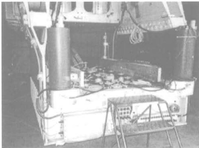
(a) Simulateur mono-axial de l'université de Californie à Davis. 1-D shaker of UC Davis University installed on the swinging basket.
