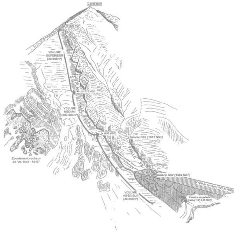
FIG. 11 Barrage de Pla de Soulcem : croquis géologique de l'appui rive gauche.
