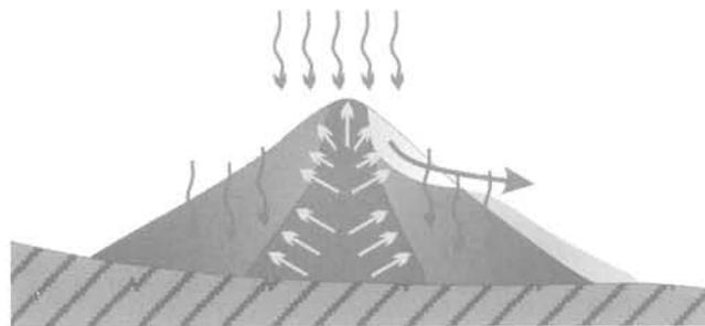
FIG. 2 Mécanisme du glissement dans un terril en combustion.
