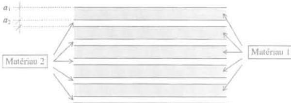
FIG. 6 Modèle idéalisé de massif stratifié.
