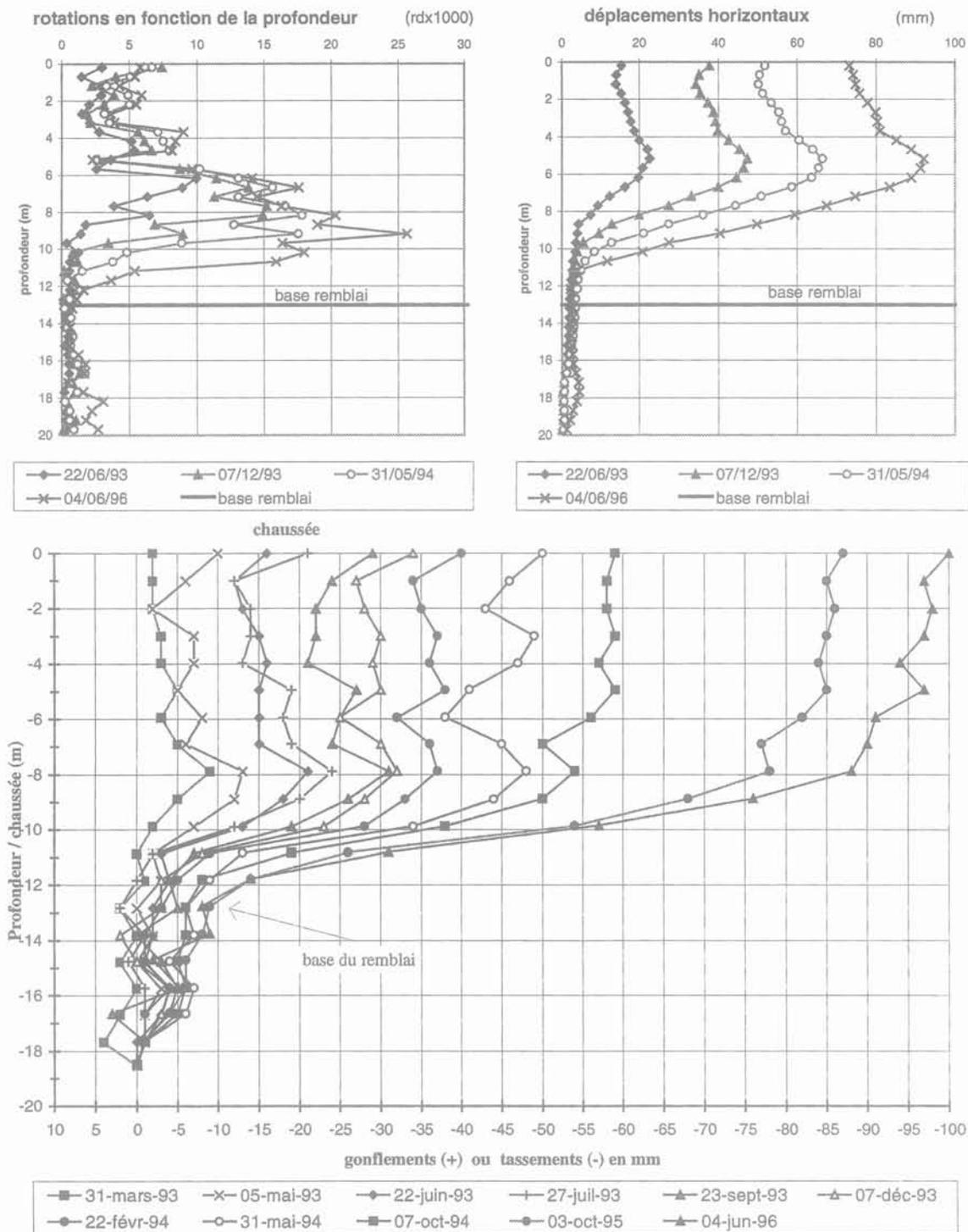
FIG. 19 Comparaison des déplacements horizontaux en crête de talus et des tassements dans l'axe d'un remblai argileux de 13 mètres de haut.
