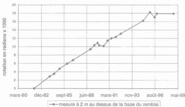
FIG. 9 Évolution des rotations à 2 mètres au-dessus de la base du remblai en fonction du temps.
