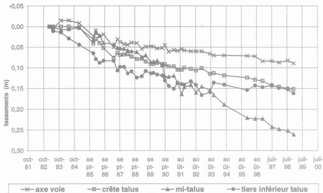
FIG. 2 Tassements différés en différents points d'un remblai de 30 mètres de haut (origine des mesures : un an après la fin de construction).
