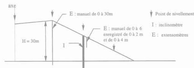
FIG. 1 Position schématique de l'instrumentation du remblai.
