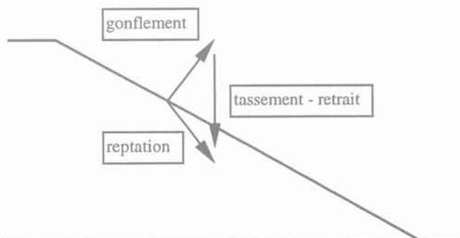
FIG. 11 Schéma de principe du phénomène de reptation de pente.
