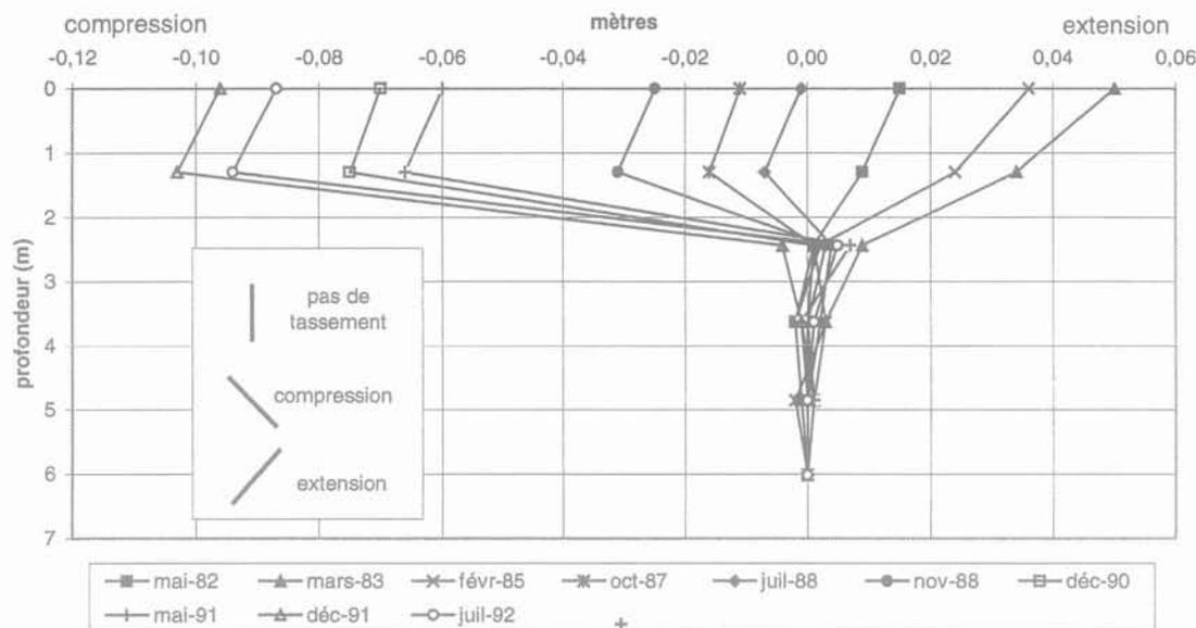
FIG. 4 Mesures des compressions - extensions de 0 à 6 mètres de profondeur (remblai expérimental de la Jorle).
