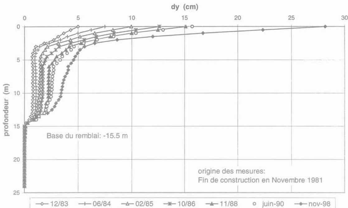
FIG. 8 Mesures inclinométriques à mi-talus du remblai de La Jorle (extraits).
