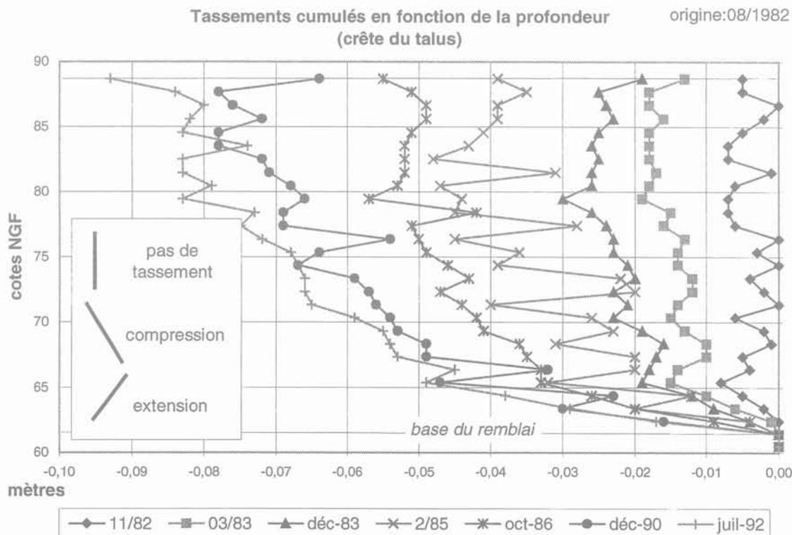
FIG. 5 Mesures des tassements et gonflements cumulés en crête du talus du remblai.
