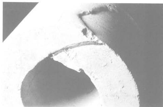
Fig. 17 Ligne de glissement macroscopique sur l'éprouvette
