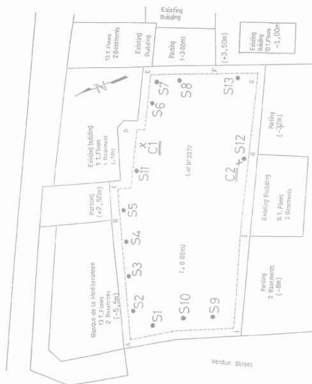
FIG. 1 Schéma d'implantation des sondages Parcelle N° 732 - VERDUN. Ech. 1/600. Boreholes location plan Plot N° 732 - VERDUN. Scale 1/600.
