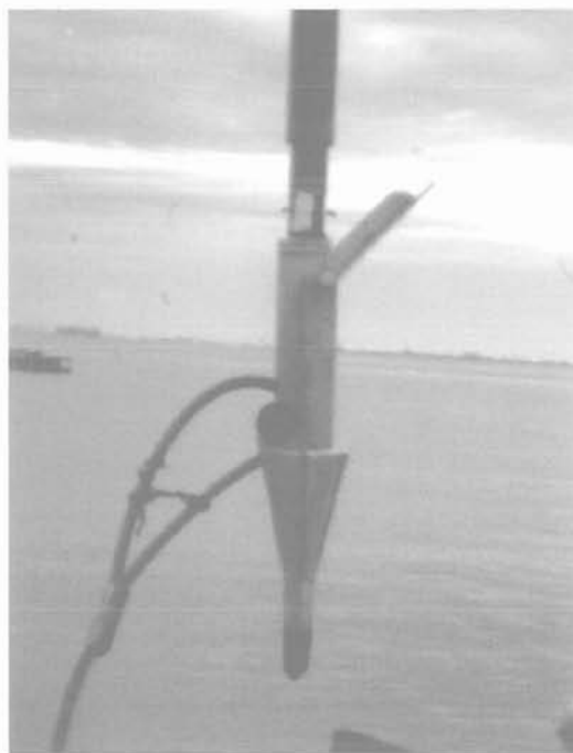
FIG. 2 Système d'ancrage à forte capacité de tenue expérimenté en vraie grandeur en fonds marins coralliens. Full scale experimentation of a high holding capacity anchoring system in coral seafloor.
