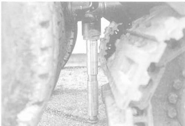
FIG. 4 Cône AMAP'sols de 50 cm<sup>2</sup> avec manchon de frottement latéral.
