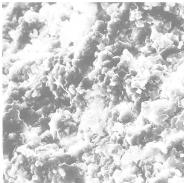
Fig. 11 Craie ayant subi une pression isotrope de 80 MPa (3,3 mm = 1 \mu )
