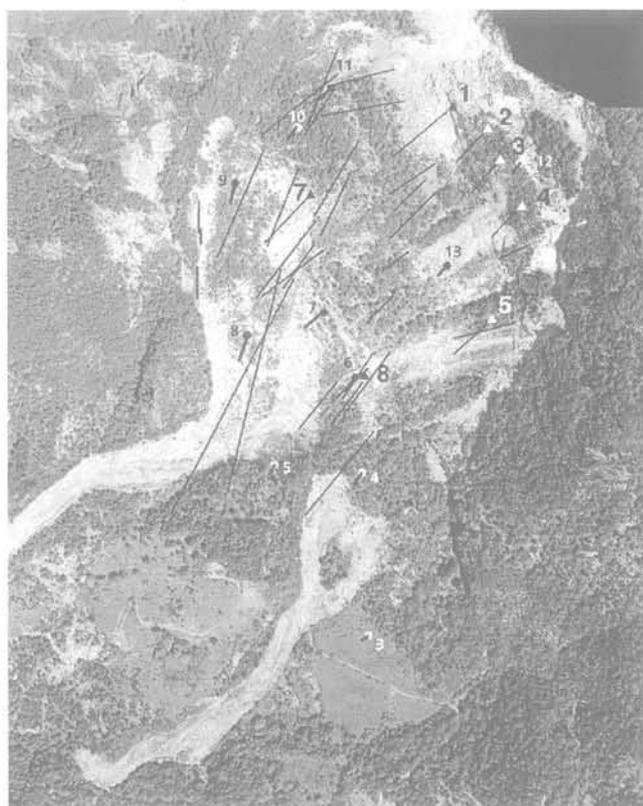
FIG. 4 Image des mouvements plans (x 20) dans les zones médiane et supérieure (en direction du SW, ou du sud) déterminés par les différentes méthodes
