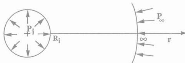
FIG. 2 Problème en déformation plane.
