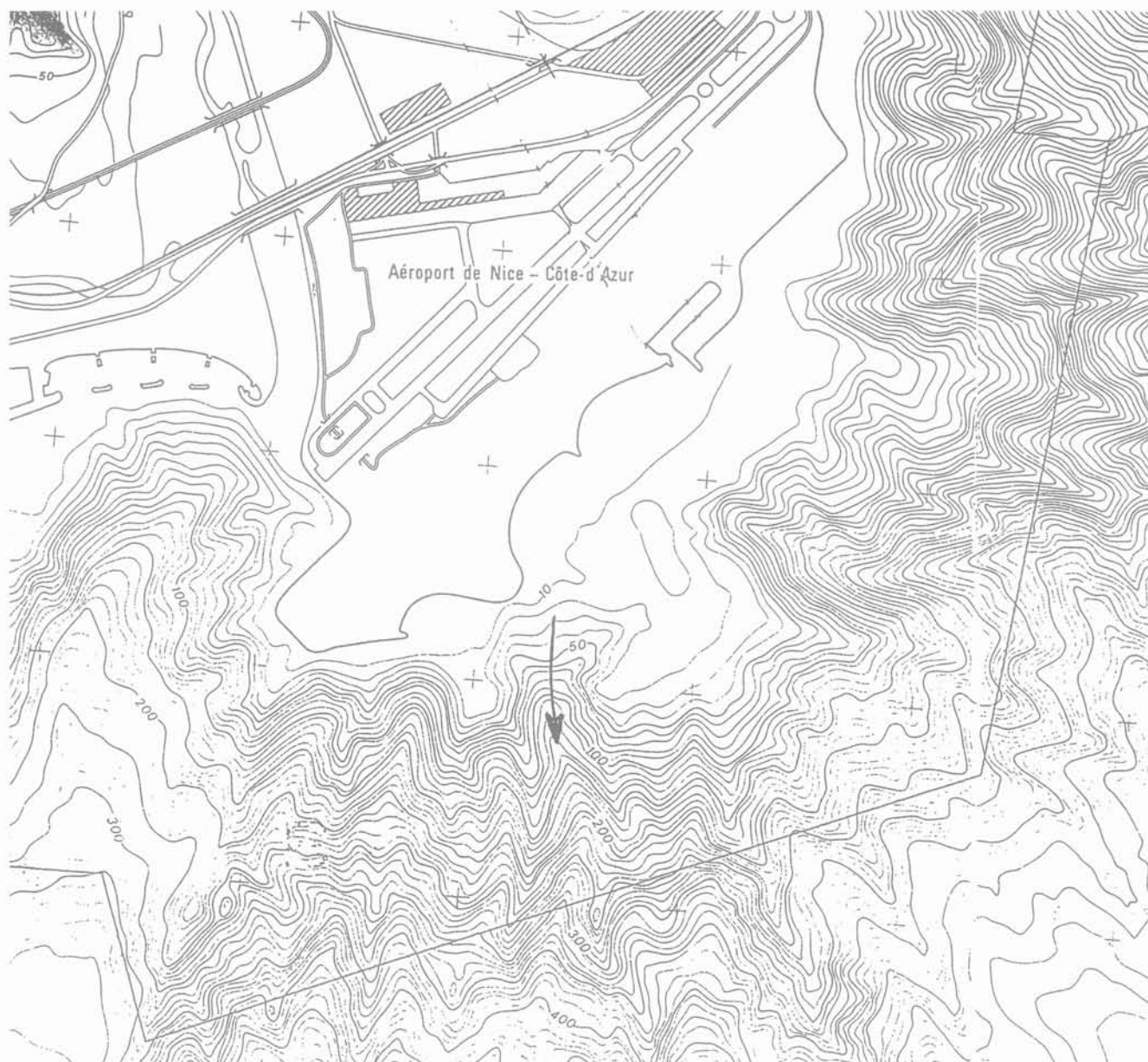
FIG. 3 Topographie du fond de la mer après l'accident. Le canyon du Var est parfaitement visible avec son fond plat. Mais sur le talus, on distingue de très nombreux sillons dont la direction est voisine des lignes générales de pente du talus. Le début de la trajectoire de l'effondrement du 16 octobre 1979 est marqué par une flèche. Sea bed topography after the slide. The beginning of the october 16th, 1979 slide trajectory is shown with an arrow.
