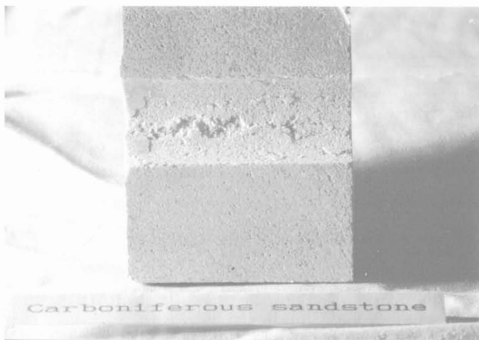
Fig. 3. — Initialisation de l'écaillage au mur d'un tube épais de grès carbonifère.
