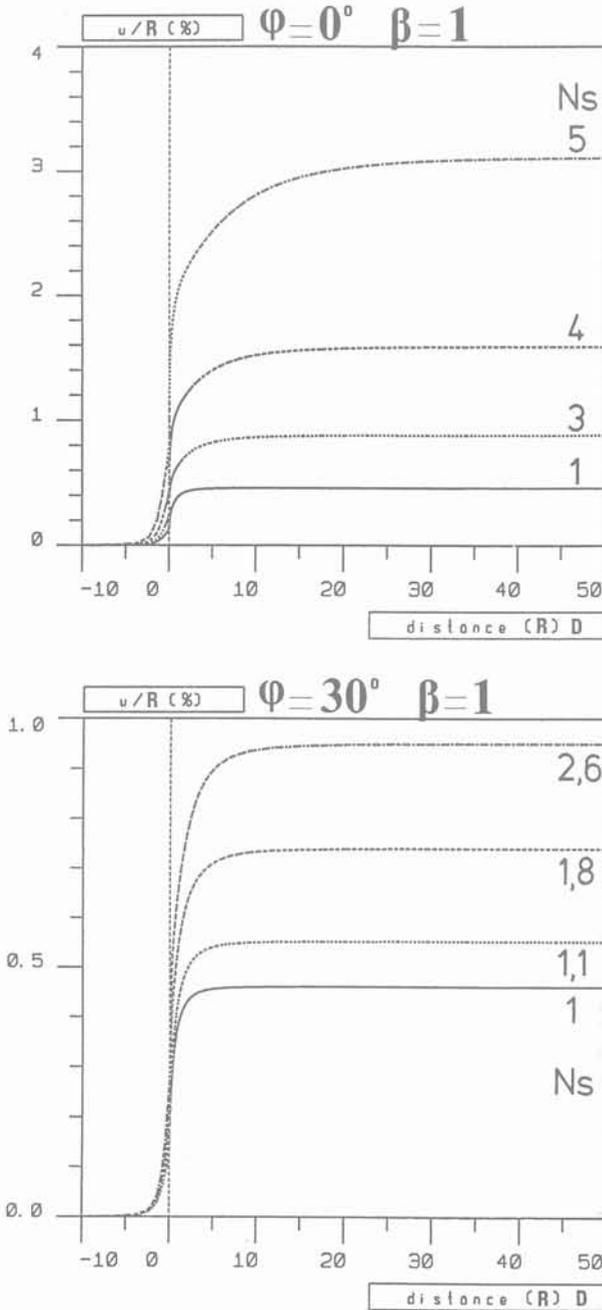
Fig. 4. — Profils de convergence en paroi  $u/R$  en fonction de la distance au front  $D$  selon le taux de chargement  $N_s$ .
