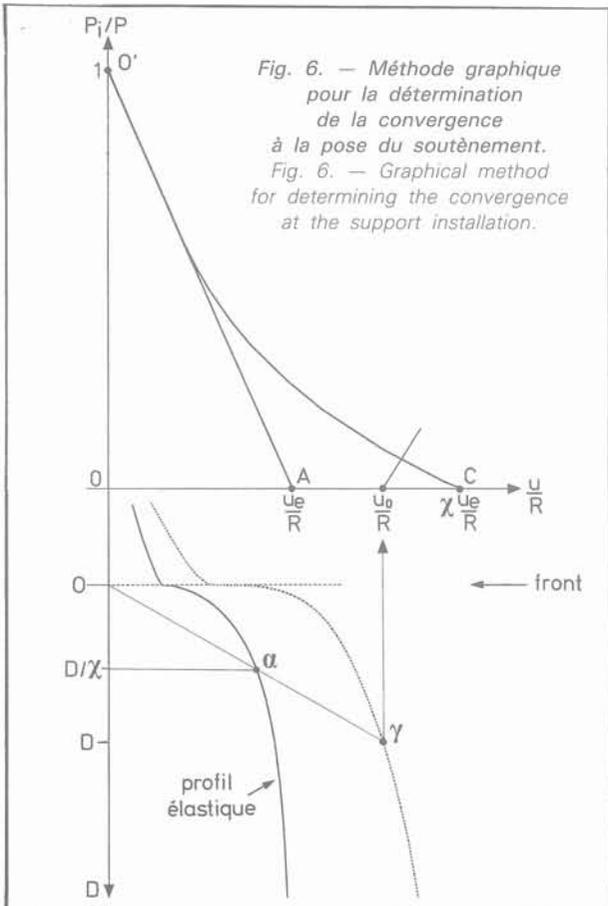
Fig. 6. — Méthode graphique pour la détermination de la convergence à la pose du soutènement.
