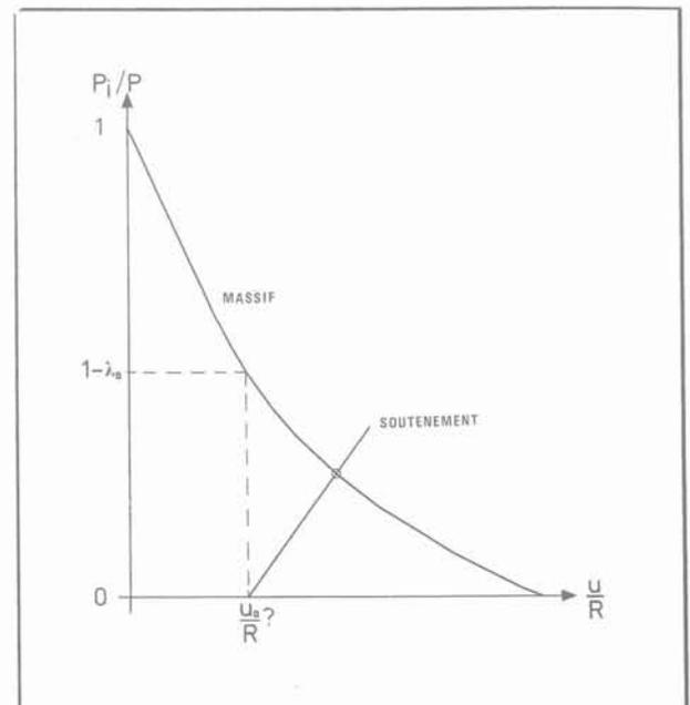
Fig. 2. — Courbes caractéristiques du massif et du soutènement.
