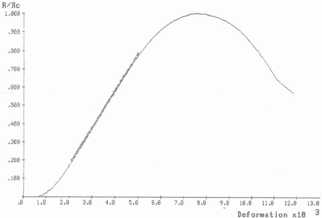
Fig. 1. — Exemple de courbe  $\sigma$ - $\epsilon$  en déformation monotone.
