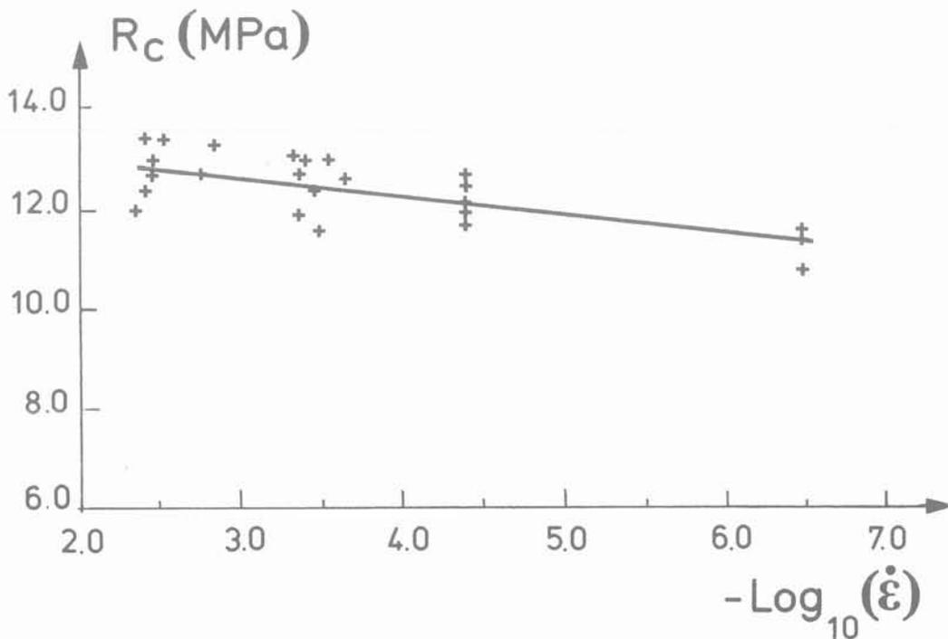
Fig. 2. — Variation de R<sub>c</sub> avec la vitesse de déformation  $\dot{\epsilon}$ .
