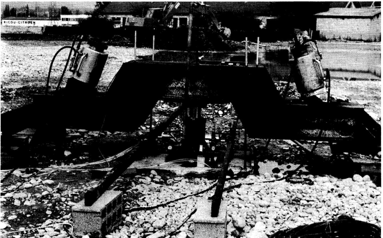
1,20 x 1,20 x 0,60 m. Cette semelle est surmontée d'une poutre métallique horizontale, avec une rotule et un dynamomètre intercalés. La poutre est chargée à ses extrémités par 2 vérins hydrauliques couplés prenant réaction sur des tirants scellés au terrain (fig. 4 bis). Le dispositif permet de développer 1 MN.
