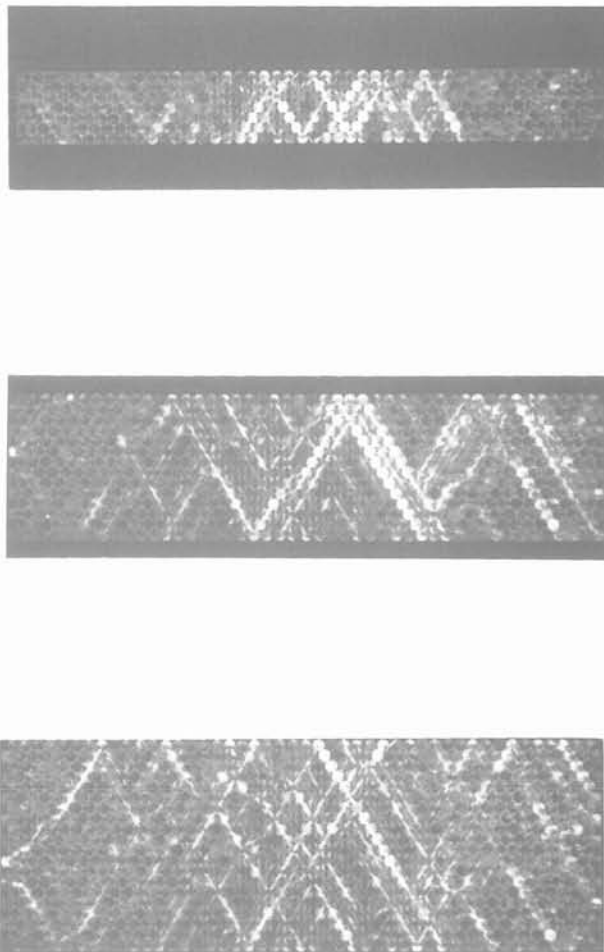
Fig. 9. — Visualisation des fortes contraintes à F = 2\,000\text{ N} pour des empilements réguliers de cylindres de plexiglas de différentes hauteurs : a) n = 7 (en dessous de la transition), b) n = 14 (dans la zone de transition), c) n = 20 (légèrement au-dessus de la transition).
