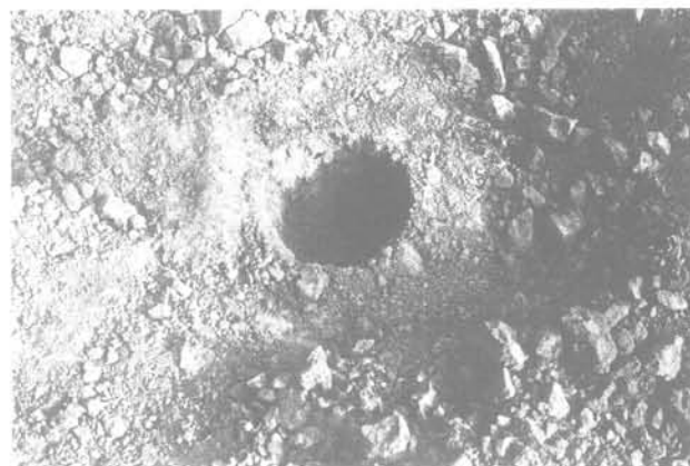
Fig. 6. — Planche d'essais. Trou creusé dans les marnes dures après six passes du compacteur 835.
