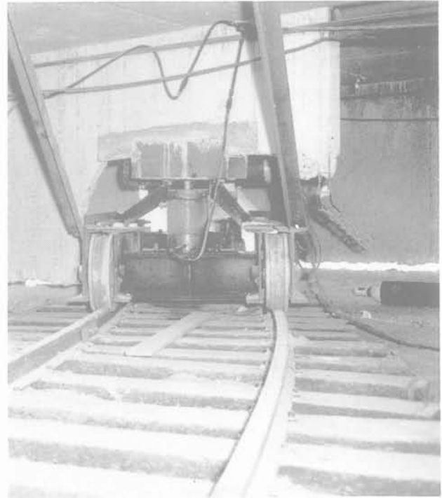
Fig. 13. – Chariot de type ferroviaire. Roues à double boudin. Charge 100 à 200 tonnes. Ils peuvent être accouplés par un berceau pour former un chariot de 200 tonnes.
