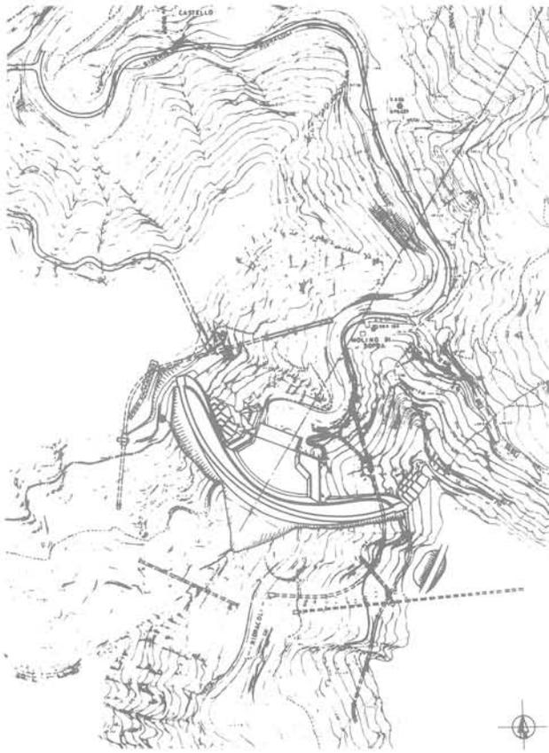
Fig. 2. — Plan de la vallée et du barrage: en pointillé galeries de reconnaissance, galeries de dérivation, et tunnel de la route d'accès au sommet de la rive gauche.
