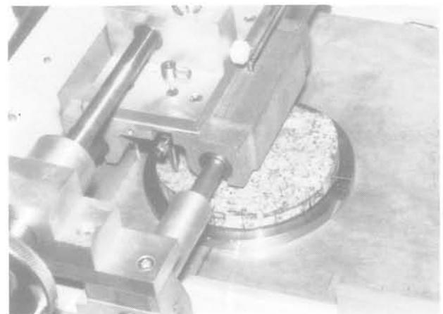
Fig. 3. — Détail du rugosimètre : chariot permettant le déplacement horizontal et palpeur.
