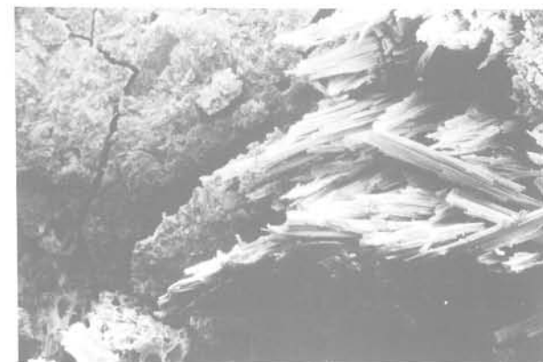
Fig. 1 à 5 Images au microscope électronique à balayage de tufs volcaniques (agglomérats de Punta Camello)
