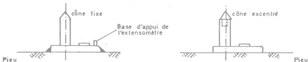
Fig. 5 Plots de mesure soudés sur le pieu
