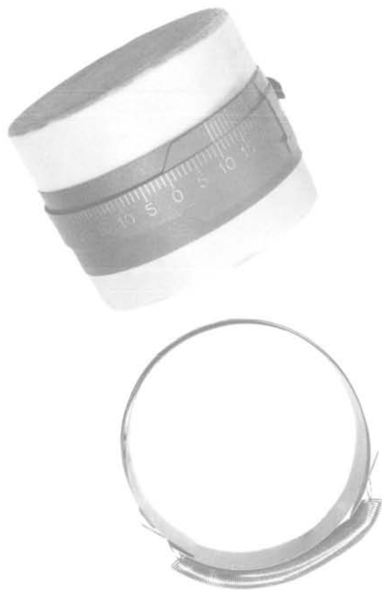
Fig. 2 Bague pour éprouvette de 50,8 mm
