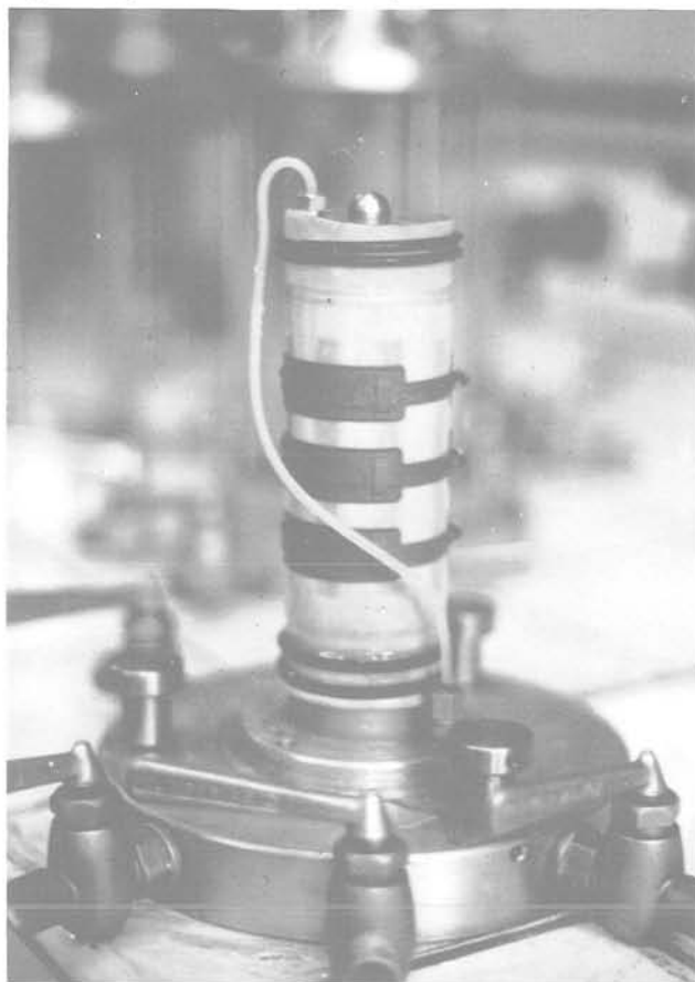
Fig. 5 Bagues montées sur une éprouvette
