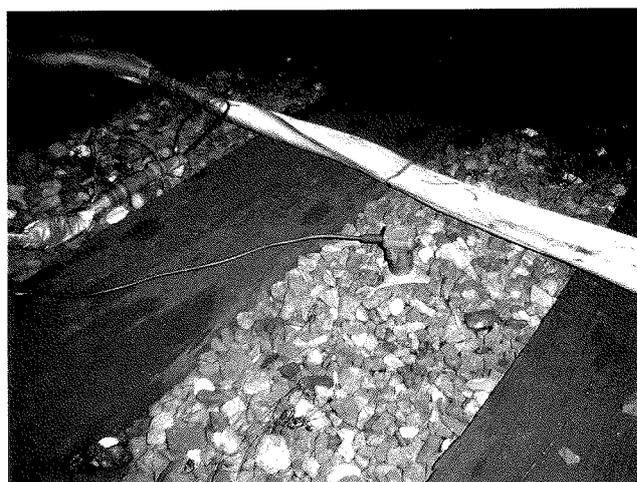
**FIG. 19** Géophone posé sur le ballast.
