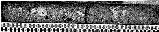
FIG. 16 Exemple de carottage de la couche de forme (échelle en cm).
