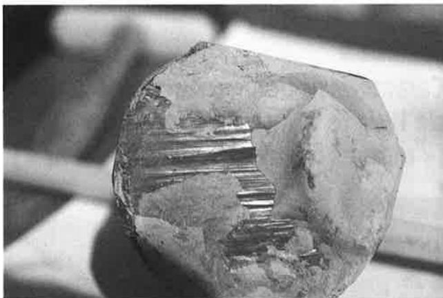
FIG. 12 Plan de cisaillement horizontal strié et poli suivant un plan de stratification. Dans la partie supérieure de la carotte, on observe un laminage (LO) parallèle au plan de stratification. On pense que ce plan de cisaillement correspond à la surface de rupture.
