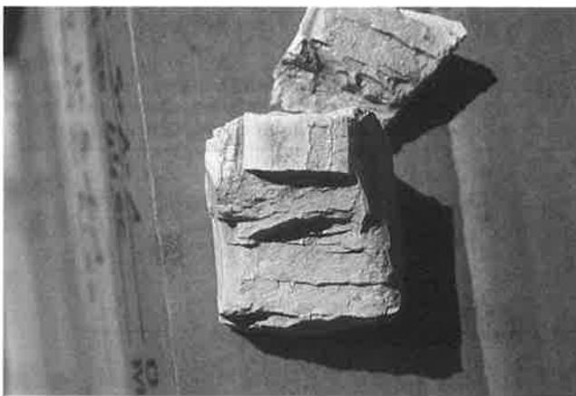
**FIG. 3** Stratification des argiles bleues : joints subhorizontaux avec espacements de 10-15 mm observés sur la carotte.
