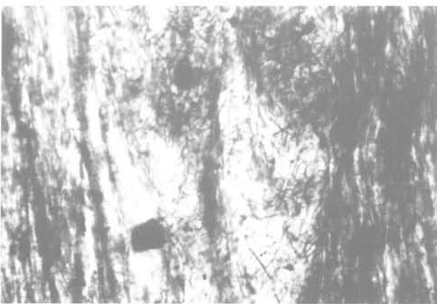
Fig. 15 bis Faciès phylliteux des schistes lustrés (échantillon 169 — PM 5092,50). Lame mince en lumière naturelle. Grossissement x 500. — Cristaux aciculaires de rutile inclus dans le quartz — lits de mica avec matière charbonneuse — dans le quartz se détachent des cristaux de pyrite noirs et trapus
