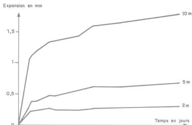
Fig. 46 PM 2295 — Expansion mesurée parallèlement à la schistosité
