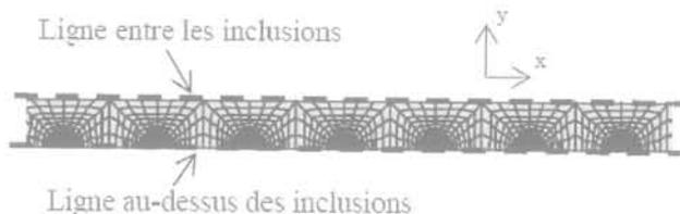
FIG. 10 Vue en plan du modèle numérique du sol renforcé par inclusions.
