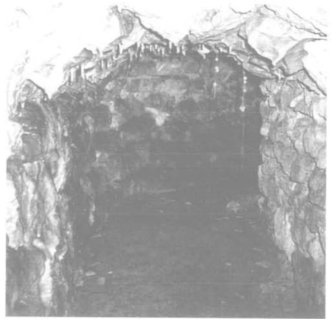
FIG. 9 Méthode d'exploitation par galeries en étoiles ou filantes (photographie Tremoureux).
