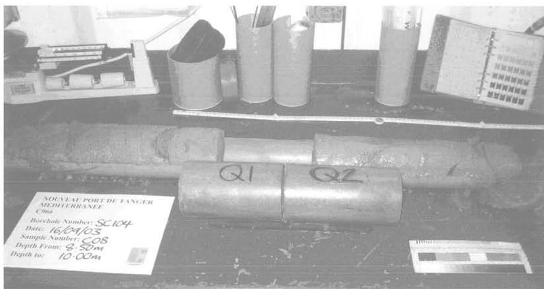
FIG. 6 Échantillons intacts dans les sables silteux.
